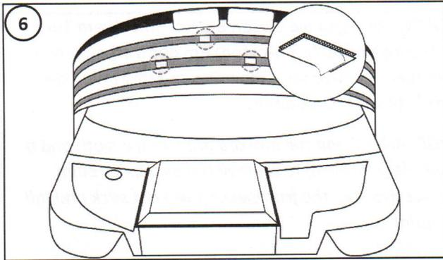
Drücken Sie die Klettbandstreifen nochmals fest an und entfernen Sie dann die zweite Folie von allen drei Streifen.
