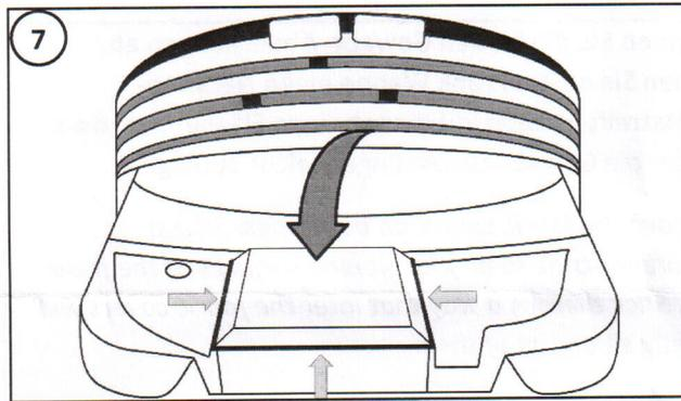
Zentrieren Sie die Frunkdichtung nochmals so gut es geht und achten Sie darauf, dass sie auch so weit wie möglich hinten sitzt. Schließen Sie den vorderen Kofferraumdeckel dann langsam, kräftig und vollständig.
