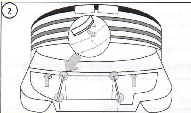
Nehmen Sie die beiden Gewebe-Abdeckungen ab. Kleben Sie an die Frunk Wanne einen Neopren-Dichtstreifen mittig auf die schrägen Flächen. So, dass später die Gewebeabdeckungen leicht aufliegen.
