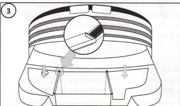
Setzen sie die Gewebe-Abdeckungen an beiden Seiten wieder ein. Diese sollten jetzt auf die Neopren-Dichtstreifen drücken. An manchen Stellen mehr, an anderen weniger stark.
