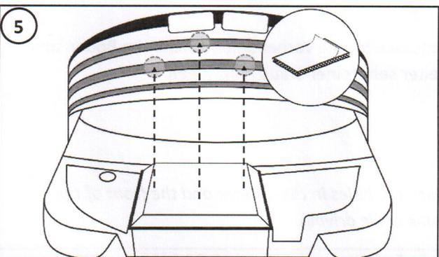
Kleben Sie nun das Klettband gemäß der Skizze an die entsprechenden Stellen des vorderen Kofferraumdeckels. Als Hilfe können Sie einen Meter gerade ansetzen um die Stelle leichter zu finden.
