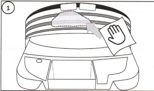
**WICHTIG!** Reinigen Sie diesen Bereich mit einem Tuch und Lösungsmittel (z.B. Aceton) um den vorhandenen Lacknebel zu entfernen. Ohne diesen Schritt wird die Frunkdichtung nicht halten!
