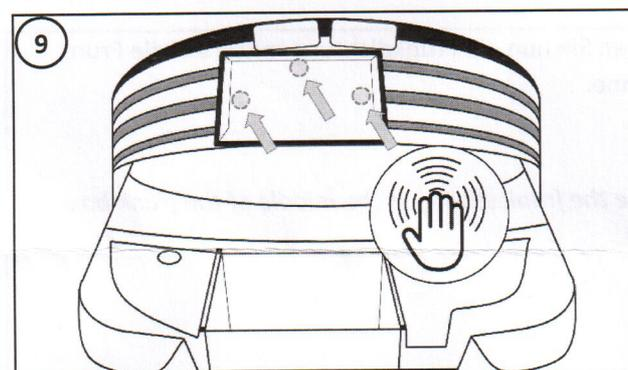
Nachdem Sie den vorderen Kofferraum wieder geöffnet haben, drücken Sie nochmals kräftig an den Stellen wo sich das Klettband befindet und Sie sind fertig. Ihr Frunk ist nun wasser- und schmutz dicht!
