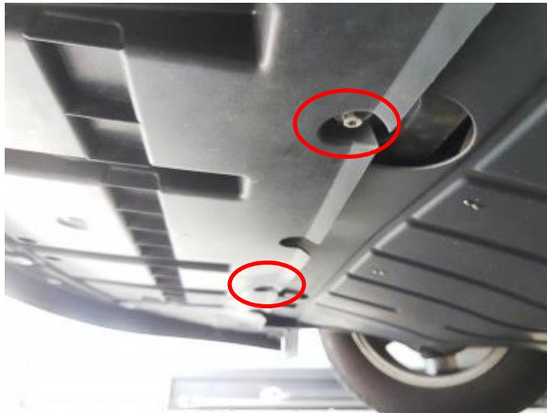
An jeder Seite sind außerdem jeweils zwei Torx T20 Schrauben zu lösen. Hier das Bild von zwei Schrauben in Fahrtrichtung links.
