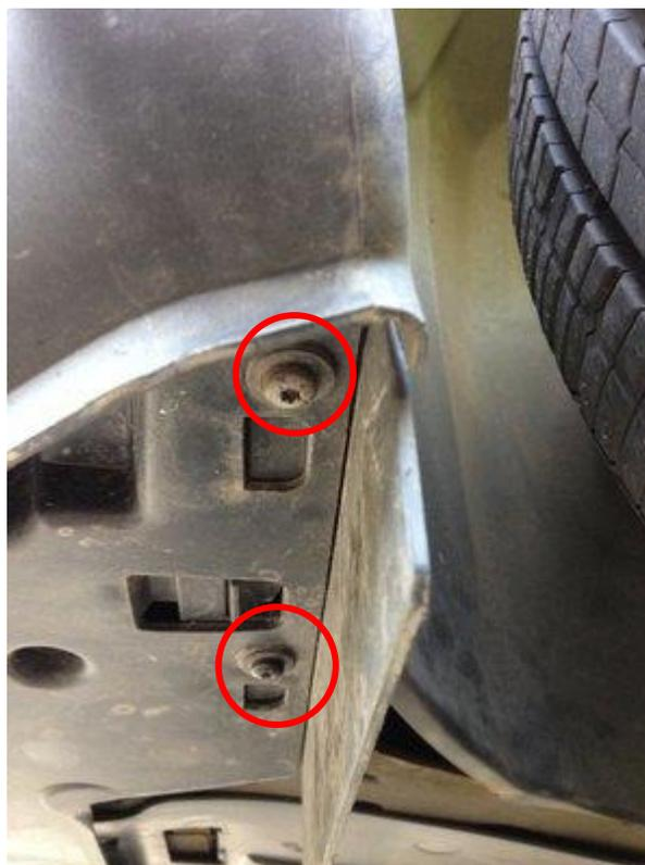
Dann die beiden Schrauben (10-Sechskant-Schlüssel) rechts und links am Radkasten lösen. Im Bild ist
