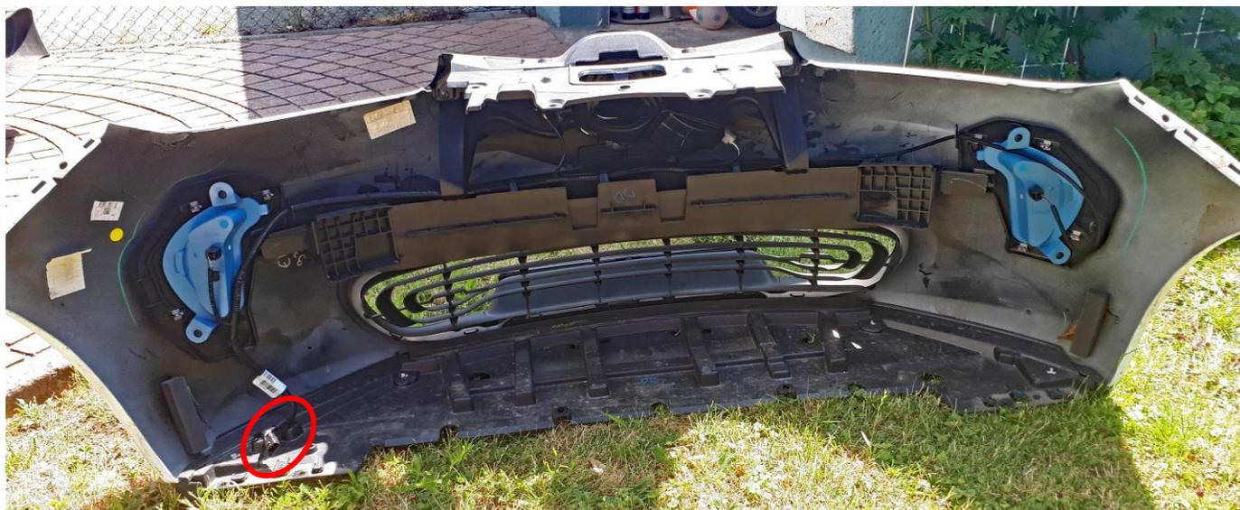
Man sieht im roten Kreis den Anschlußbereich für den Batterie-Überlauf und den Anschlußstecker der Beleuchtung.
