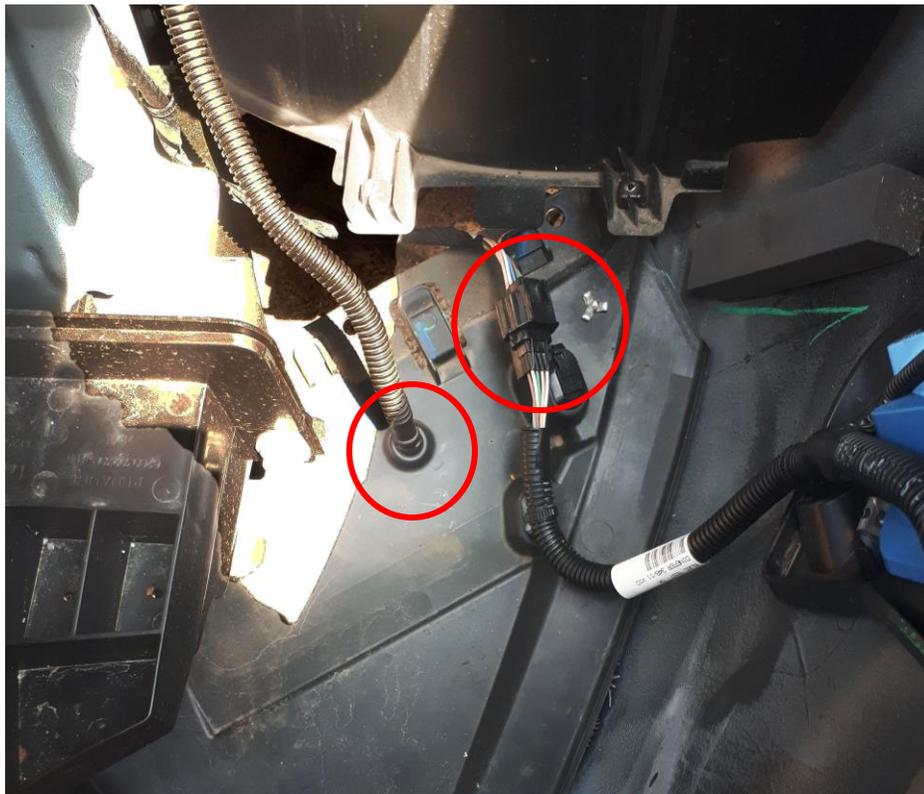
Mit der Hand in die Öffnung fassen und rechts den Stecker trennen. Ebenso die Überlaufleitung der 12V-Batterie links entriegeln. Jetzt das Frontteil auf der rechten Seite ausklinken und das Teil ganz abnehmen.
