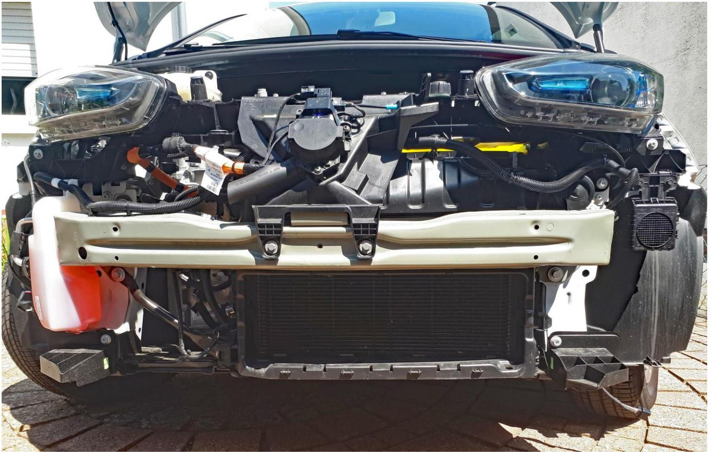
Von vorne gesehen befindet links sich der Kondensierer oder Verflüssiger der Wärmepumpe - und rechts ist das Fußgänger-Soundmodul und die Hupe.
