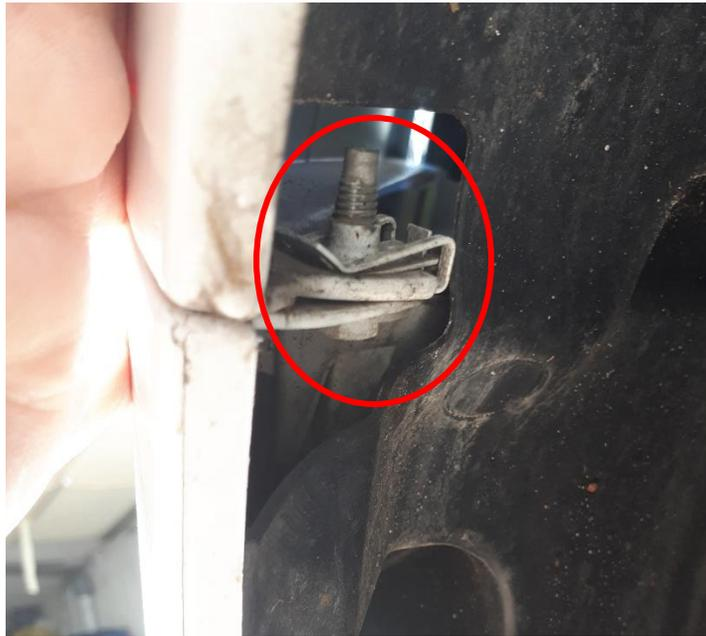
Zuletzt die vier Schrauben (10-Sechskant-Schlüssel) im Motorraum von oben aufschrauben.
