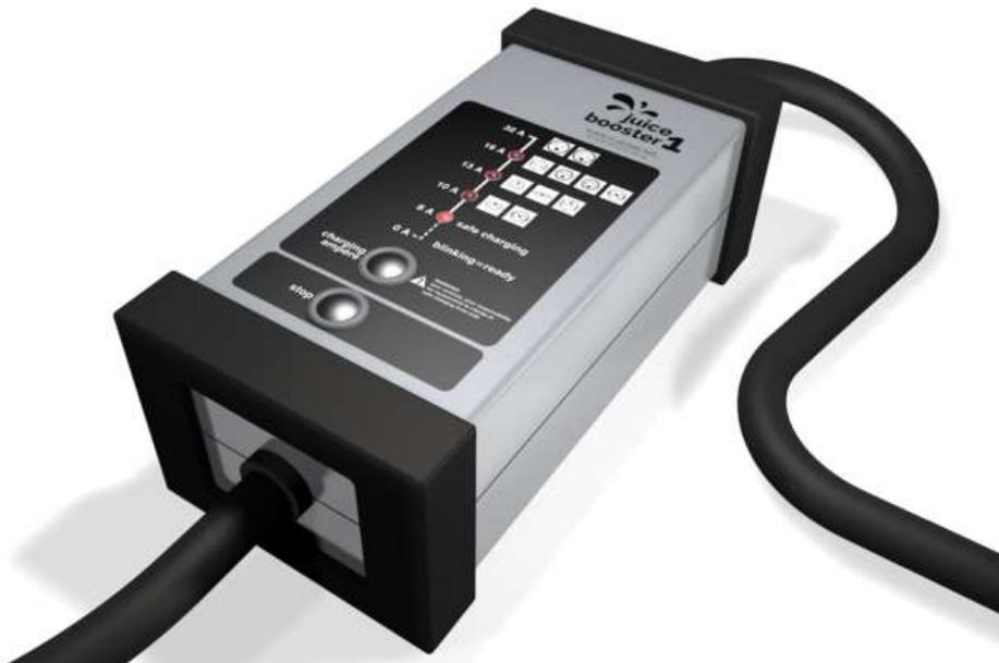
Anschluss erfolgt mit einem CEE32 Stecker. Kann mit Zwischenstecker auf den jeweiligen Anschluss Schuko, CEE-230V/16A, CEE-400V/16A angepasst werden. Die Ladeleistung ist je nach Stecker durch die Stromstärke einstellbar. (max. 22kW)
