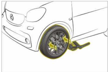
Reifen mit vorgeschriebener Laufrichtung nur entsprechend ihrer Laufrichtung montieren. Ein Pfeil auf der Seitenwand des Reifens kennzeichnet die Laufrichtung.
