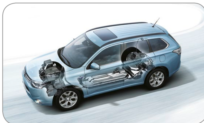
Der Benzinmotor und jeweils ein Elektromotor vorn und hinten treiben den Plug-in Hybrid Outlander an.
