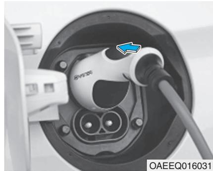
7. Schließen Sie den Ladestecker an den Ladeanschluss an. Drücken Sie auf den Stecker, bis Sie ein Klickgeräusch hören. Wenn der Ladestecker und die Ladeklemme nicht korrekt angeschlossen sind, besteht die Gefahr eines Brandes.
