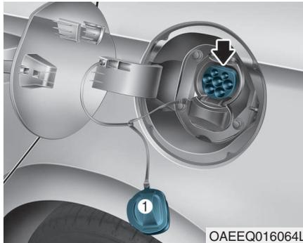
5. Entfernen Sie die Abdeckung (1) des Ladeanschlusses.
