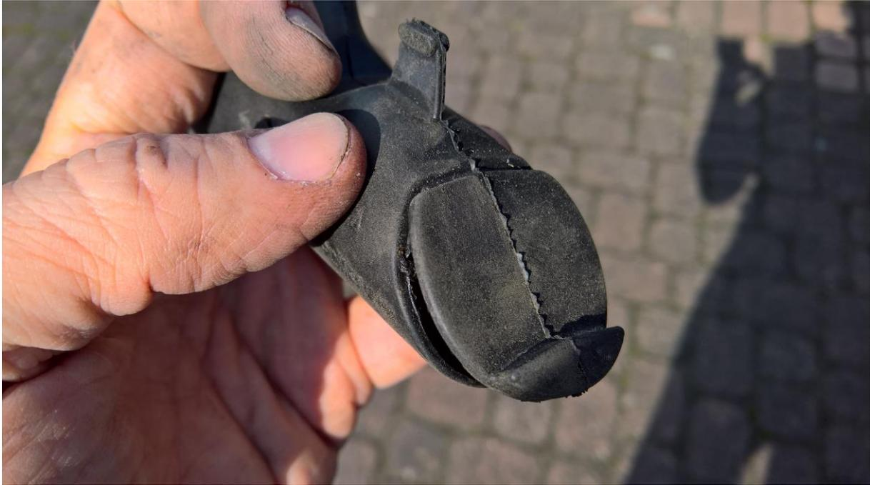
Klappe am unteren Ende des Ablaufschlauches.
