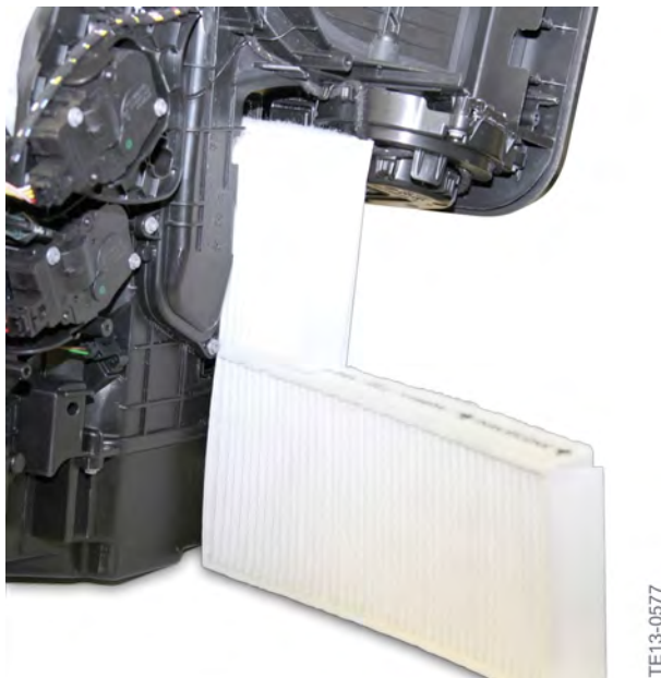
Heiz-Klimagerät Mikrofilteraustausch
