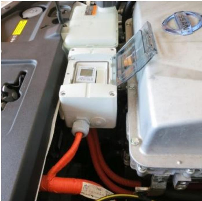
Das eingebaute Messgerät ermöglicht die Anzeige /Messung von entnommener Strommenge, Wirk- und Scheinleistung, Netzspannung, Stromaufnahme und Netzfrequenz. Die Materialkosten dafür betragen 61 Euro.
