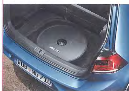
Subwoofer und Verstärker als kombinierte Einheit in der Reserveradmulde
