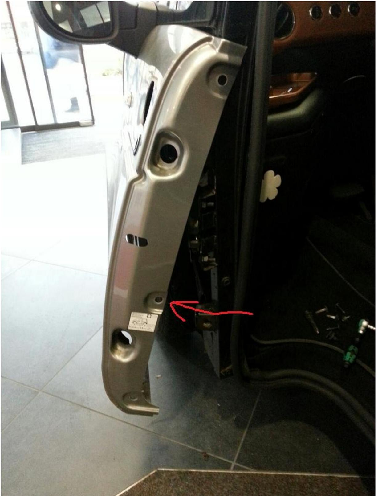
7. Nun die 2x Torx T30 lösen und das Türschloss 1) nach vorn für mehr Spannung damit die Tür beim erstenmal aufspringt 2) wenn Spannung zu groß in Richtung Heck verschieben
