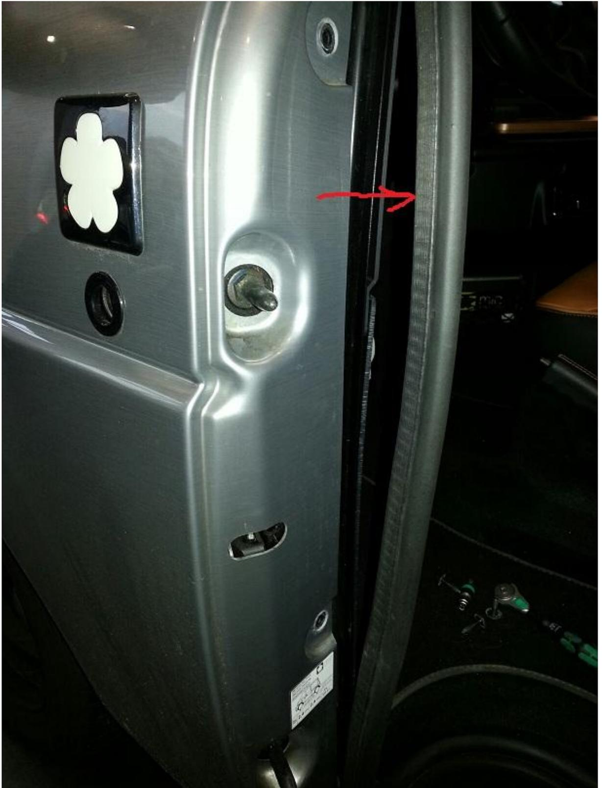
3. unteren Dorn mit gekröpften Ringschlüssel 16mm entfernen
