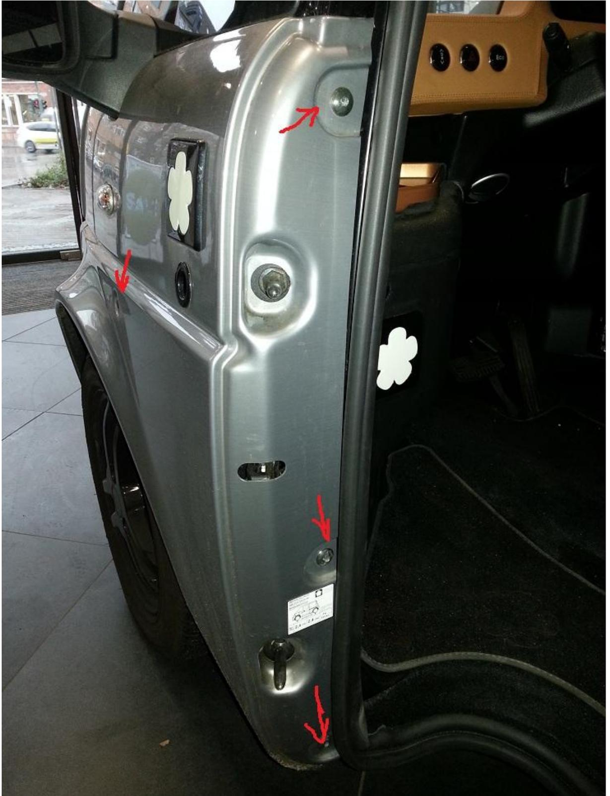
2. Dichtung von Karosserie lösen
