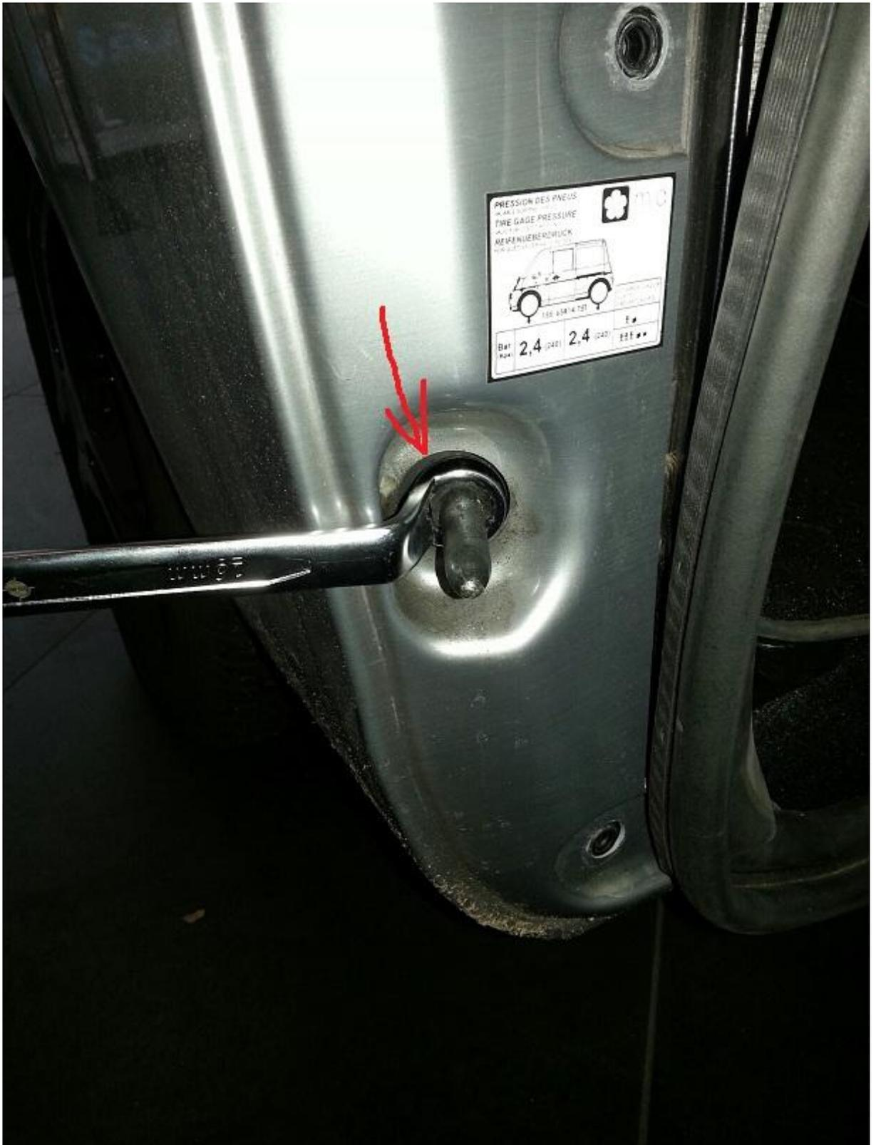
4. untere Schraube vom Kotflügel Torx T30 entfernen und Spreizkopf am Clip lösen und entfernen
