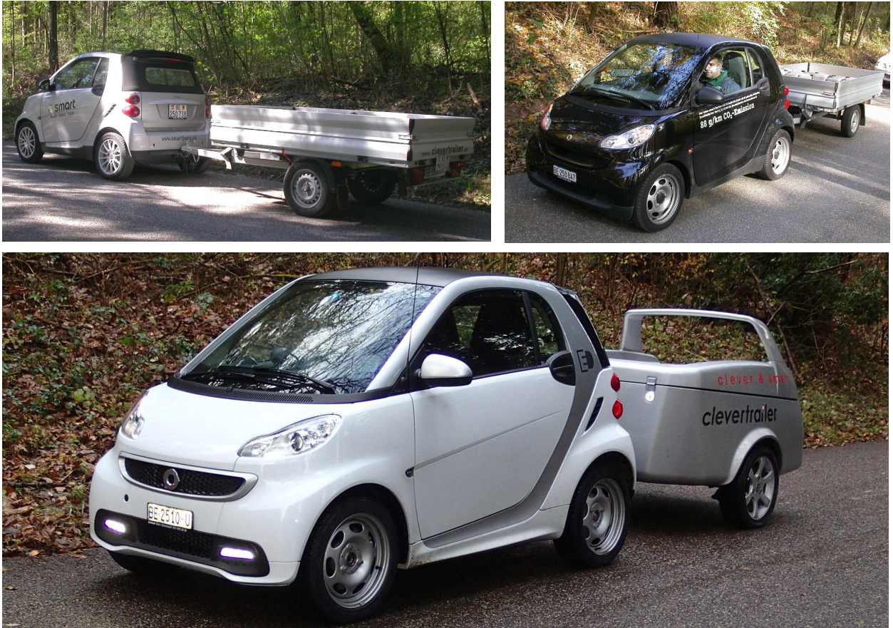
Abb. 5: Überprüfung des Anfahrvermögens (links: Versuchsfahrzeug 1, rechts: Versuchsfahrzeug 2, unten: Versuchsfahrzeug 3)
