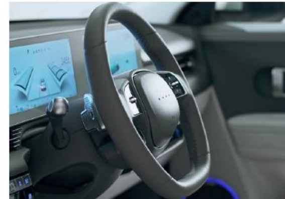
Beheizbares Zweispeichenlenkrad Schaltwippen zur Einstellung der Rekuperation (beides serienmäßig)
