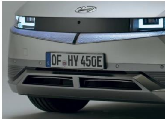
aktive Luftklappen in der Frontschürze zur Kühlung der Hochvoltbatterie: Vergleich geschlossen gegenüber geöffnet (serienmäßig)
