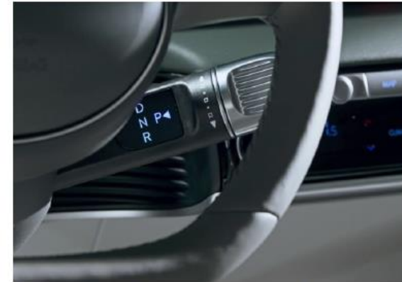
Shift-by-Wire per Wahlhebel an der Lenksäule (serienmäßig)
