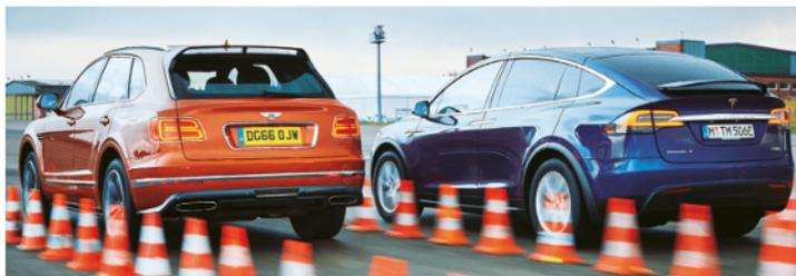
**Der (teure Carbon-)Spoiler am Bentley-Heck steht fest, der am Tesla-Heck fährt aus, sobald der Fahrer die Tür zum Einsteigen öffnet**
