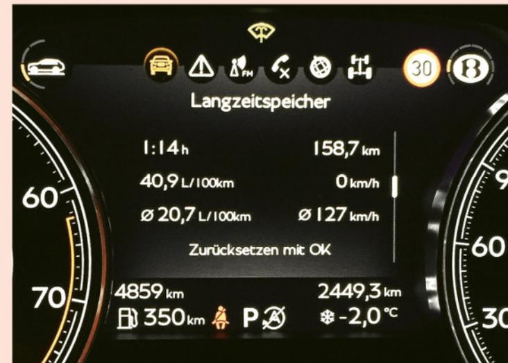
**BENTLEY:** Bei Tempo 200 dreht der Benziner 2600 Touren und verbraucht im Schnitt 20,7 Liter. Die Reichweite schrumpft auf 350 Kilometer
