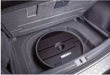
Ungestört: Anstelle des Reserverads sorgt der Match-Subwoofer für tiefe Bässe, das Ladevolumen bleibt unangetastet.
