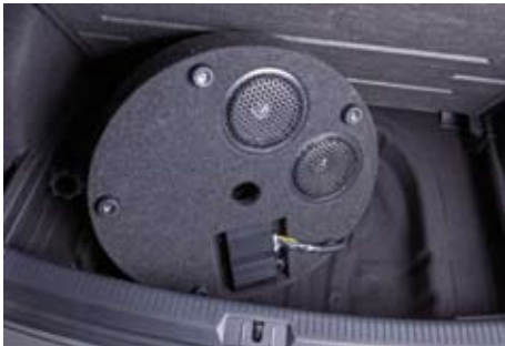
Alles drin: Beim Soundsystem für den VW Golf VII ist der Verstärker direkt in den Reserverad-Sub integriert, was den Einbauaufwand minimiert.
