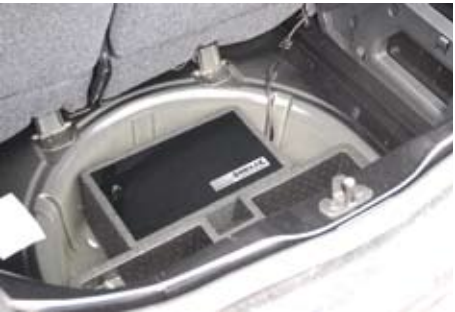
Etwas anders: Im VW up! sitzt der Verstärker hinter dem Armaturenbrett an der A-Säule, der Mini-Subwoofer ebenfalls in der Reserveradmulde.
