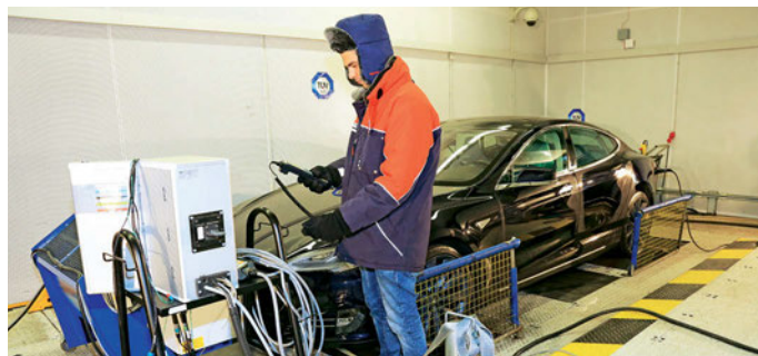
Der Minus-sieben-Grad-Test nach dem TSECC stellt die Akkus und Heizsysteme vor eine besonders schwere Aufgabe
