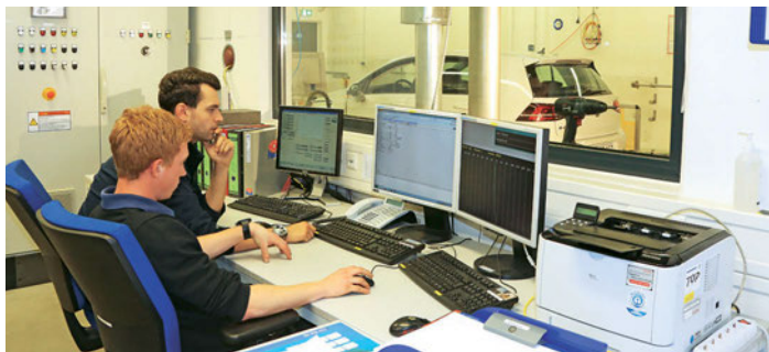
Auf dem temperaturkontrollierbaren Rollenprüfstand des TÜV SÜD wurden die Basis-Reichweiten ermittelt
