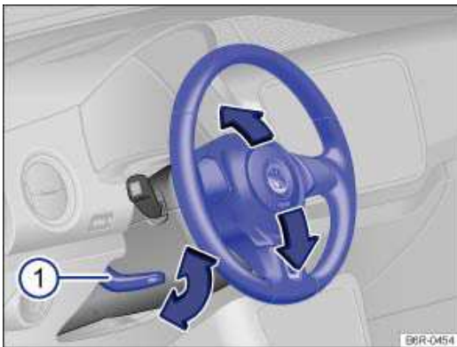
Abb. 44 Lenkradposition mechanisch einstellen.
