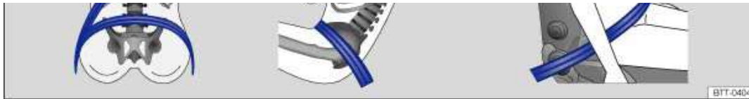
Abb. 55 Richtiger Gurtbandverlauf und richtige Kopfstützeinstellung.
