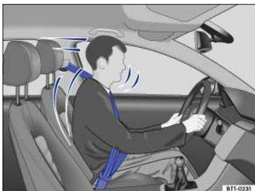
Abb. 52 Angegurter Fahrer, der bei einem plötzlichen Bremsmanöver vom richtig angelegten Sicherheitsgurt aufgefangen wird.
