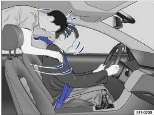
Abb. 51 Der nicht angegurte Mitfahrer auf dem Rücksitz schleudert nach vorn auf den angegurten Fahrer.
