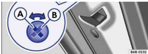
Abb. 29 In der hinteren linken Tür: Kindersicherung (A) ausgeschaltet, (B) eingeschaltet.
