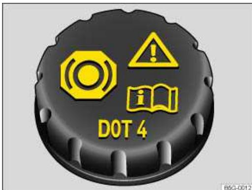
Abb. 103 Im Motorraum: Deckel des Bremsflüssigkeitsbehälters.
