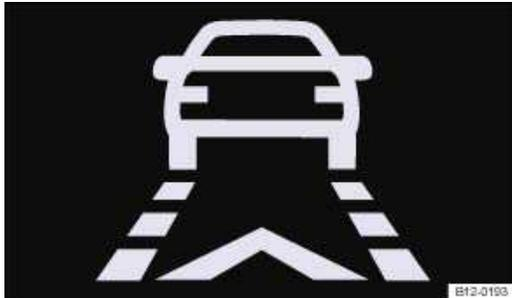
Abb. 117 Im Display des Kombi-Instruments: Anzeige der City-Notbremsfunktion.
