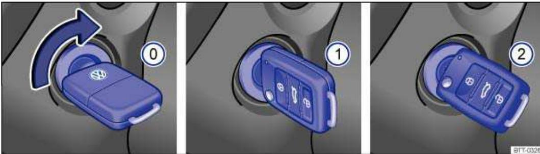
Abb. 95 Positionen des Fahrzeugschlüssels im Zündschloss.
