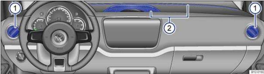
Abb. 124 In der Instrumententafel: Luftaustrittsdüsen.
