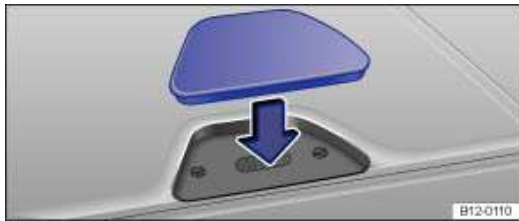
Abb. 14 Auf der Mittelkonsole: Öffnung der Aufnahme des Navigationsgeräts verschließen.
