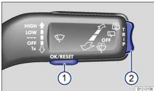
Abb. 12 Scheibenwischerhebel: Taste ① zum Bestätigen und Wippe ② zum Wechseln der Anzeige.
